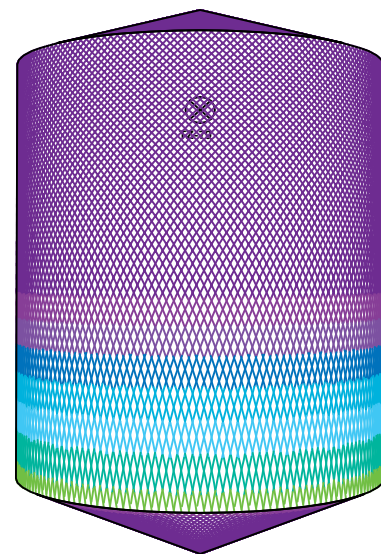
Pr. 8 m Al 10 m, Toftejorg MultiJet 50, 4 x ø10 mm 0 % Tiempo = 23,3 min., Consumo de agua = 10868 l
