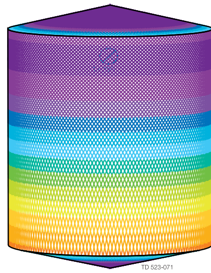
Pr. 4,6 m Al 5,5 m, Toftejorg MultiJet 25,4 x ∅5,5 mm, tiempo = 8,3 min, Consumo de agua = 1612 l
